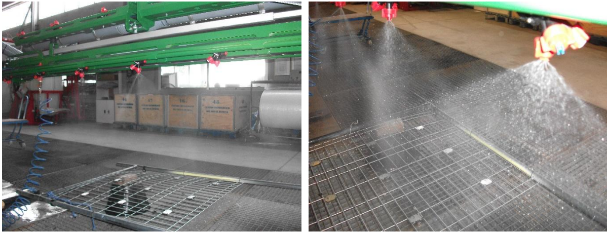
Ensayos de cobertura electrostática con prototipo en laboratorio.
