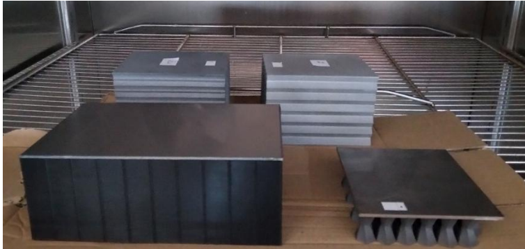
Exposición de muestras de materiales a ambientes en cámara climática.
